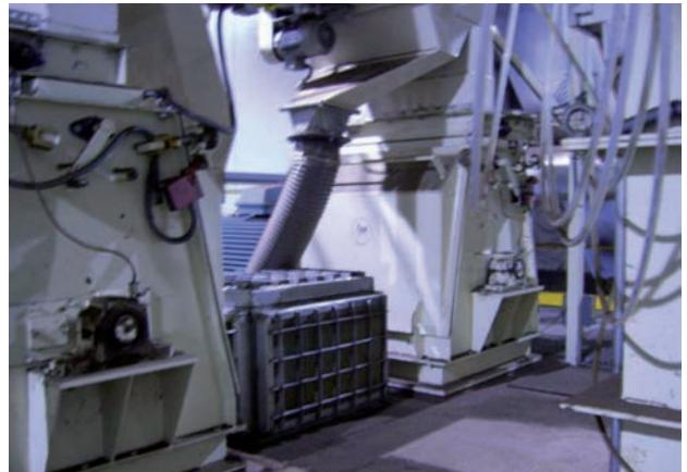
Figura 33 - Venteo sin llama en tolva de molinos de martillos.
