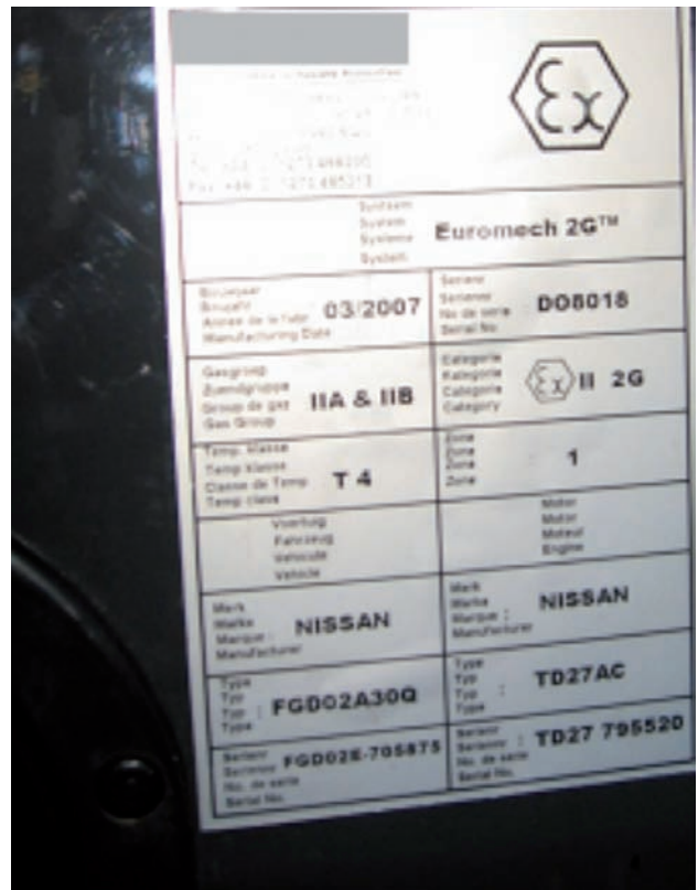
Figura 39 - Marcado de equipos no eléctricos.
